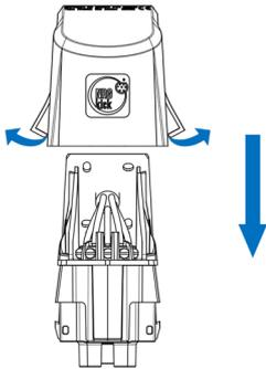
Setzen Sie den Oberteil auf den Unterteil auf. Biegen Sie die beiden untersten Stellen des Oberteils leicht nach außen. Achten Sie darauf, dass die Führungsschiene des Oberteils korrekt in das Unterteil eingeführt wird und schieben Sie das Oberteil dann nach unten bis die Verschlusshaken einrasten.
