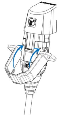
Richten Sie die Sperrverriegelung so aus, dass die Verriegelungsstifte unten platziert sind. Danach führen Sie die beiden Verriegelungsstifte in die Löcher der Steckereinheit ein.
