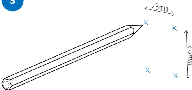
Markieren Sie die Bohrlöcher wie im Bild angegeben. Alternativ können
