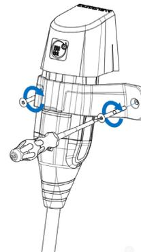
Bringen Sie die Sperrverriegelung wieder in die zuvor beschriebene Position und befestigen Sie sie an den zwei dafür vorgesehenen Stellen an der Wand (auf fachgerechte Befestigung entsprechend des Wandaufbaus achten).
