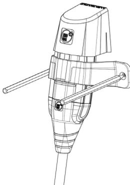
Setzen Sie an den beiden Löchern der Sperrverriegelung eine Markierung. Danach entfernen Sie die Sperrverriegelung und bohren die Löcher anhand der Markierungen.
